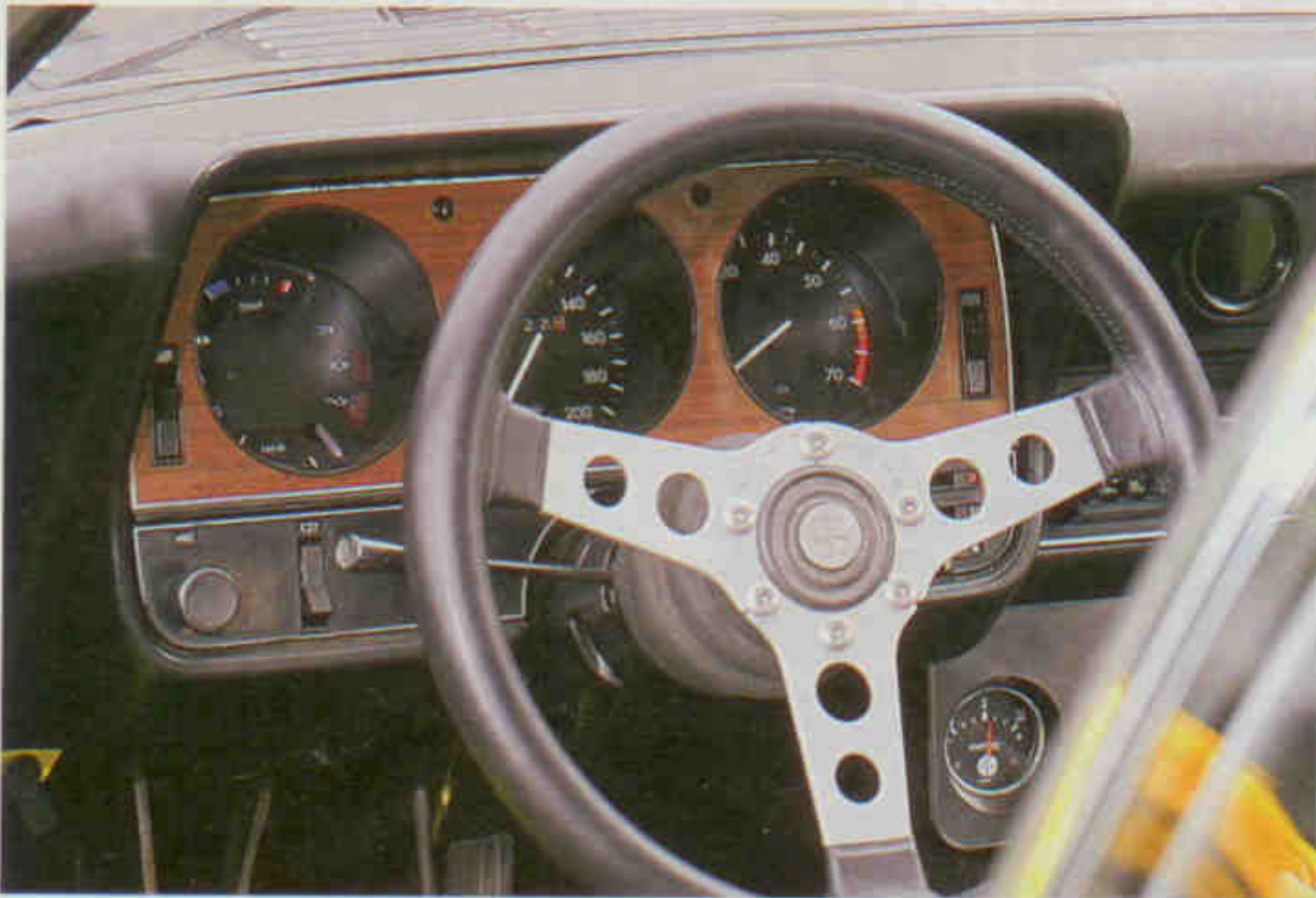
Fast wie damals in Rüsselsheim: Der Instrumententräger entspricht der Serie, Zusatzinstrumente, Überrollbügel und Lochspeichenlenkrad geben dem Ganzen den sportiven Touch
