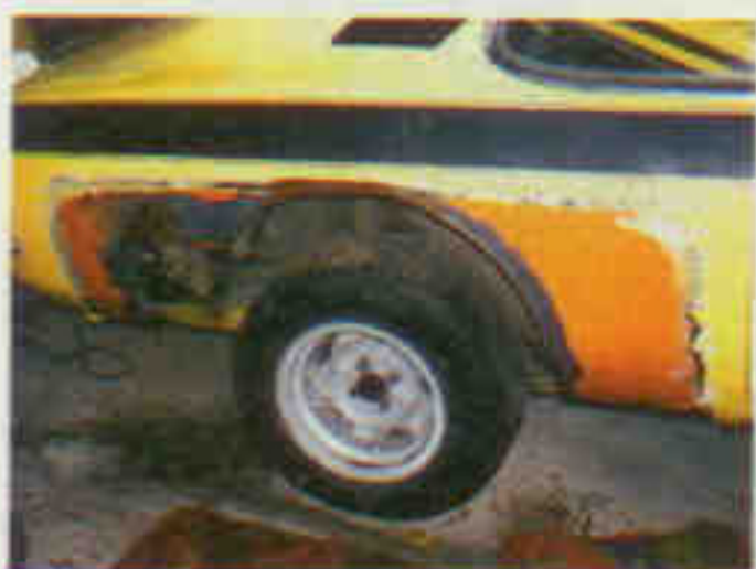
So breit, so faul: Unter den Verbreiterungen wartete Rost
